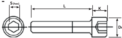
Dimensions to BS EN ISO 4762 DIN 912
